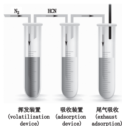
图1 在线裂解-吹扫捕集装置示意图
